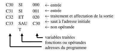
© Programmation du calcul logique d'une fonction "ET" avec stockage du résultat sur un bit interne, puis utilisation de cette information dans le déroulement d'un programme :
